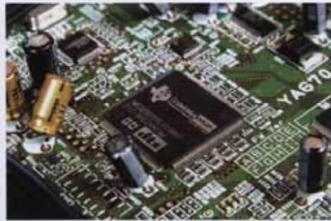
使用德州仪器的32bit音频解码芯片，另外还提供了CINEMA DSP 3D音场功能
